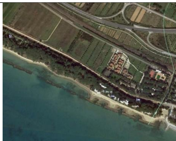
Figura 9. Il settore tra Torre Mozza e Baia Toscana. Litorale difeso da opere in ingegneria rigida (dx) e litorale difeso da beach rock (sx).
